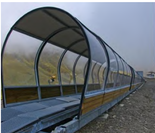
Exemple d'un tapis à l'architecture qualitative : arceaux mâts et foncé et soubassement bois
