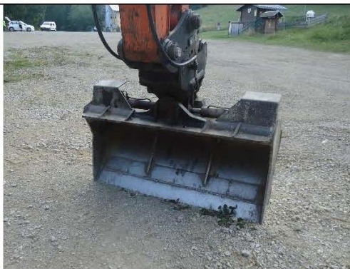
Modèle de godet à utiliser (type godet de curage)
