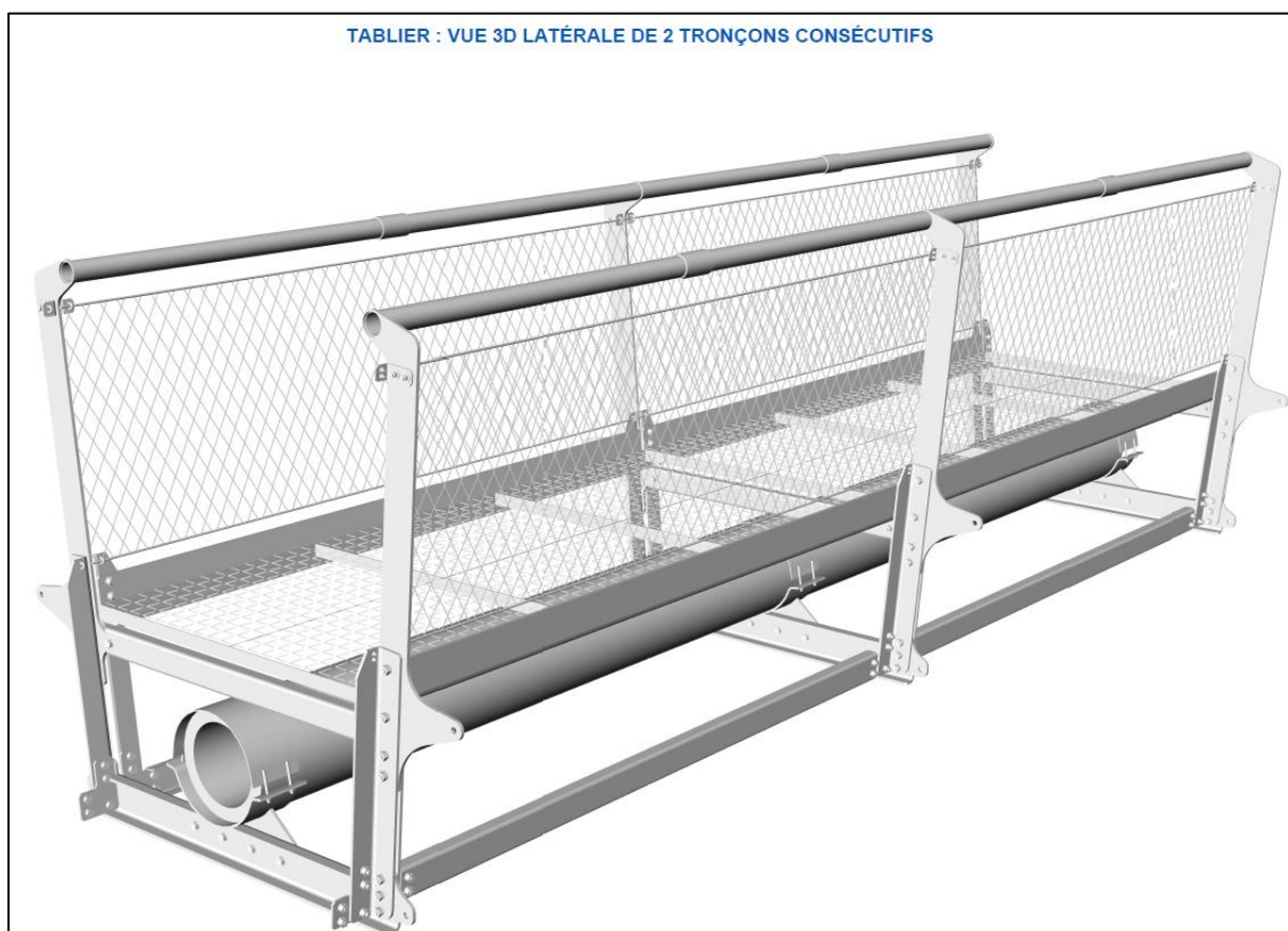
Figure 5 – Vue latérale de 2 tronçons consécutifs de la passerelle soutenant la canalisation d’eau potable.
