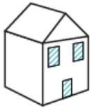
Ouvertures petites au rythme régulier ; Menuiseries en bois d'aspect naturel ; Des linteaux en bois peuvent être présents, formant un chaînage double aux fenêtres ou simple aux portes.
