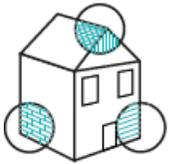
Murs en pierre hourdée de chaux ou absence d'enduit ; Charpente et balcon en bois local ; Toiture en lauzes ou toiture métallique si rénovée.
