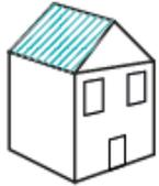
Toiture à deux pans à pentes faibles reposant sur des murs pignons ;
