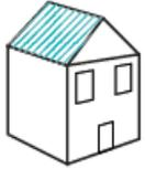
Toiture à deux pans reposant sur des murs pignons; Débord de toiture large sur l'ensemble des faces de la construction.
