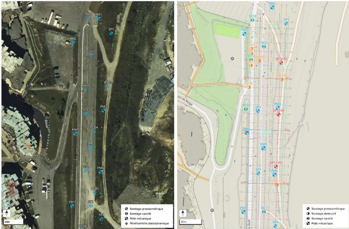
Figure 12 : Sondages et investigations géotechniques réalisés au droit du site : étude géotechnique G2-AVP à gauche études géotechnique G2-PRO et G5-PRO à droite
