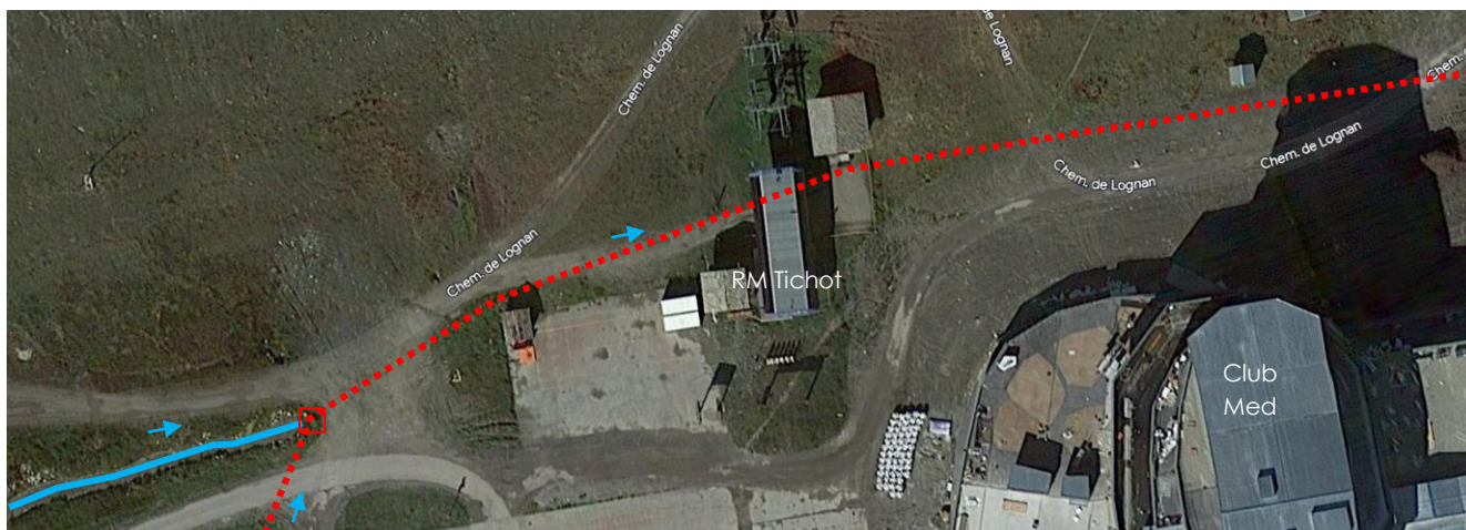
Figure 12 Vue aérienne du tronçon T4 (pointillés : section busée) (18.09.2022, google Earth)
